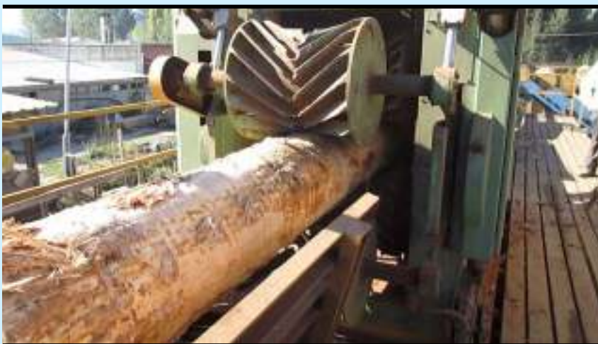
Máquina descortezadora trabajando sobre postes de pino.
