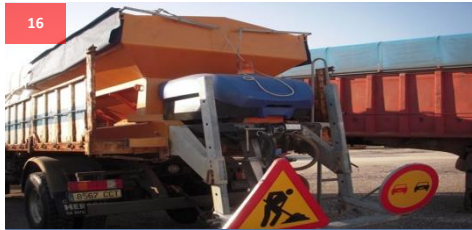
SALERO / SALT SPREADER SCHMIDT ESTRATOS MODELO B5-030VCLNCS. AÑO/YEAR 2005.
